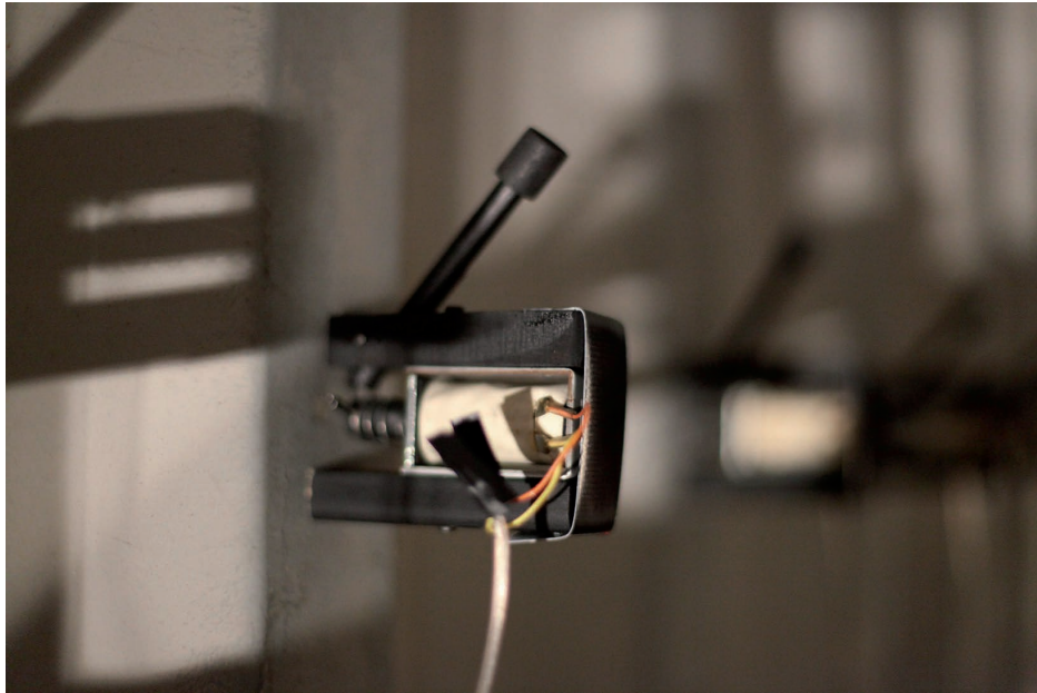
Figura 12.33. | Solenoides montados en la pared del contenedor.
