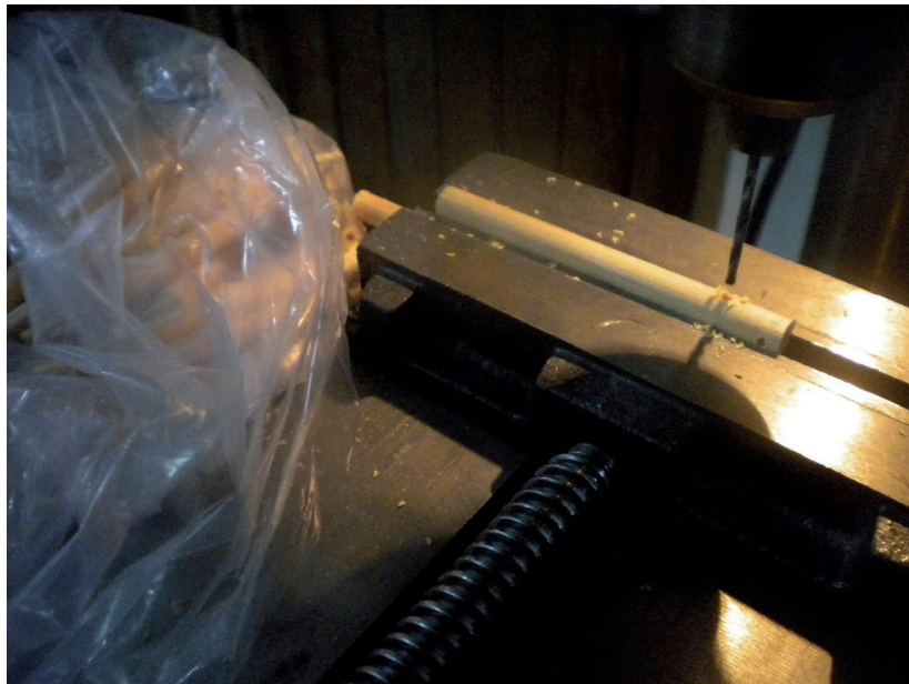
Figura 18.11. Perforación de baquetas para percutores.
