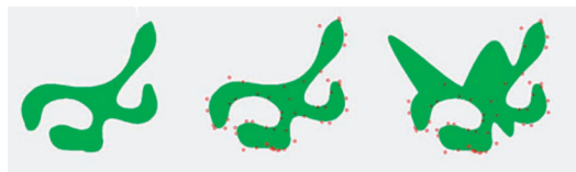
Figura 16.18. | Método de Newton Raphson para la conversión de trazos en curvas de Bezier.
