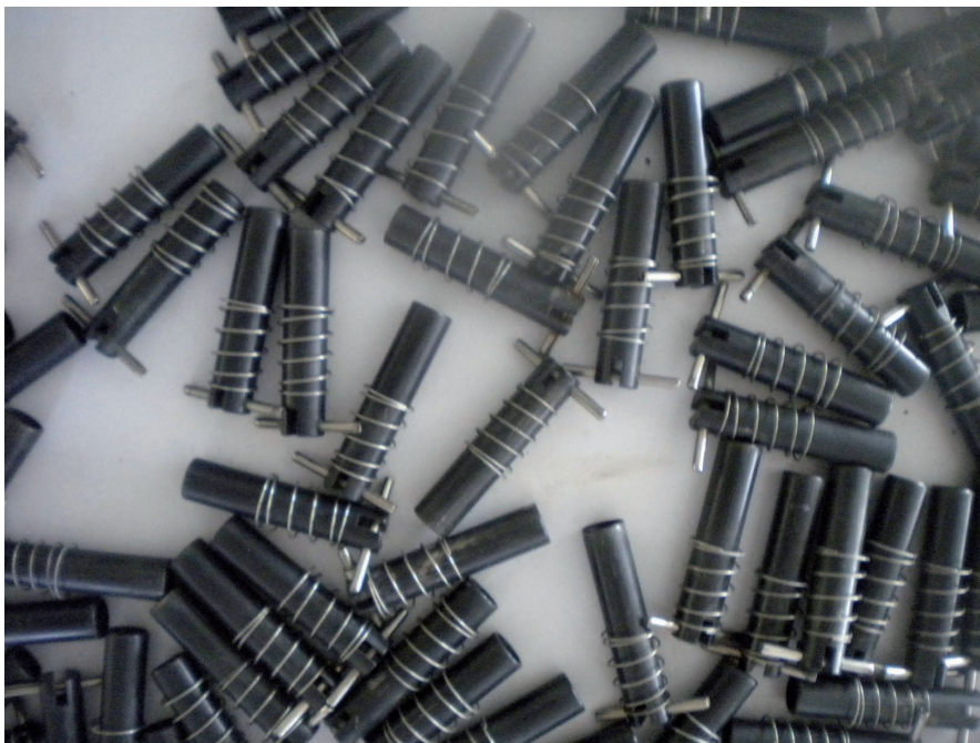
Figura 18.13. Calibración y colocación de resortes para solenoides.
